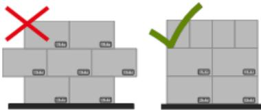
La arrumabilidad de las cajas debe hacerse en columnas haciendo coincidir las esquinas y con el último tendido cruzado, arrumando máximo 4 cajas, ya que de no hacerlo de esta manera las paredes se deformarán.
